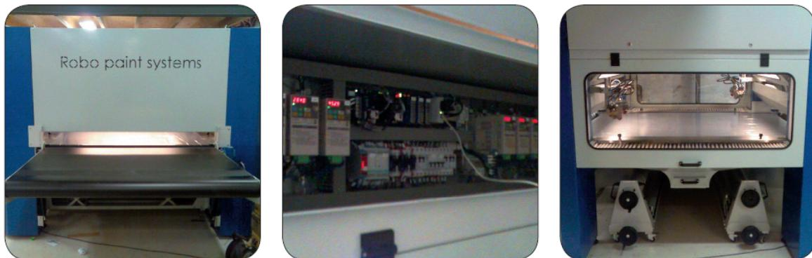
Compact er en dansk produseret travers sprøyte maskine som er en af de mest kompakte travers sprøyte maskiner i verden med plastfoliebånd. Maskine er bygget solidt og udstyret med tekniskkendte komponenter af bedste kvalitet, den er udstyret med et meget bruger / service venligt panel på 10 tommer, som sikre en meget fleksibel maskine. Maskinen er ligeledes udstyret med lysbro for automatisk emne aftastning, som sikre minimalt forbrug af maling.
